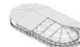
Le marcheur ovale Teomatic est disponible avec une couverture intégrale. L'enceinte est entièrement dégagée et peut servir d'entrepôt, de paddock ou, pour des installations d'envergure, d'espace d'initiation aux sauts et à l'équitation. Charge de neige jusqu'à 5,0 kN/m<sup>2</sup>
