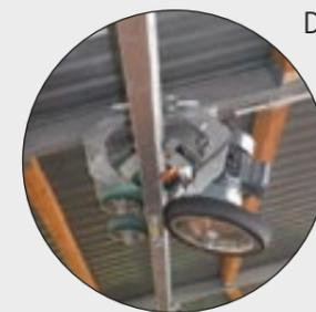
Des chariots d'entraînement placés sur un rail à deux tubes, reliés avec des barres d'entraînement et activés par deux moteurs, circulent au centre, au-dessus du pas.
