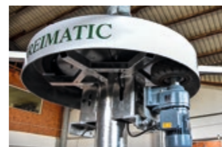
Système d'entraînement pour marcheur de chevaux de tour
