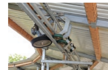
Système d'entraînement pour un marcheur de chevaux à anneau ovale
