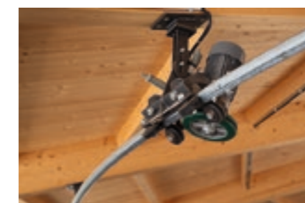
Système d'entraînement pour marcheur de rond de longe
