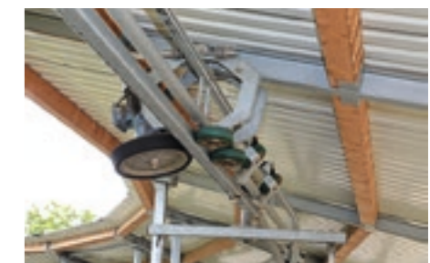
Antriebssystem für eine ovale Ringführanlage
